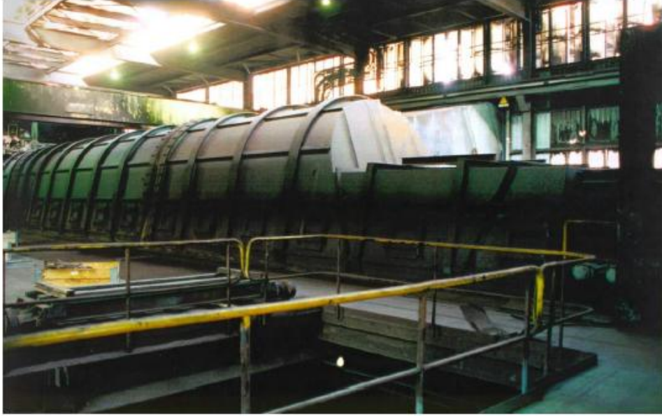
Şekil 4.16: EOS prosesine göre kapalı sinter bandı –[Panne, 1997]
