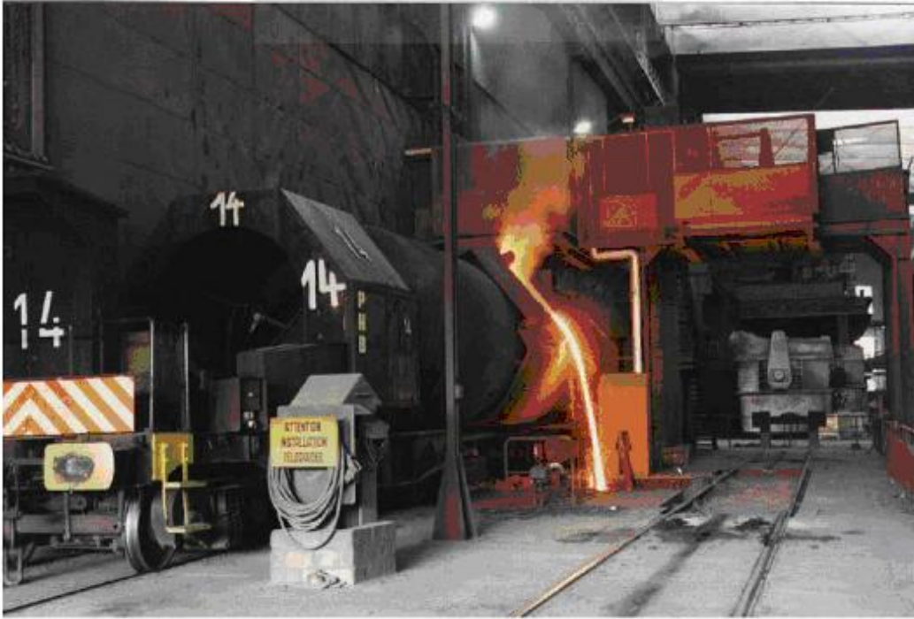
Şekil 8.21 : Torpidodan şarj alırken çıkan toz emisyonu (CO2 verilmesi ve verilmemesi durumunda) (UNEP,1997)
