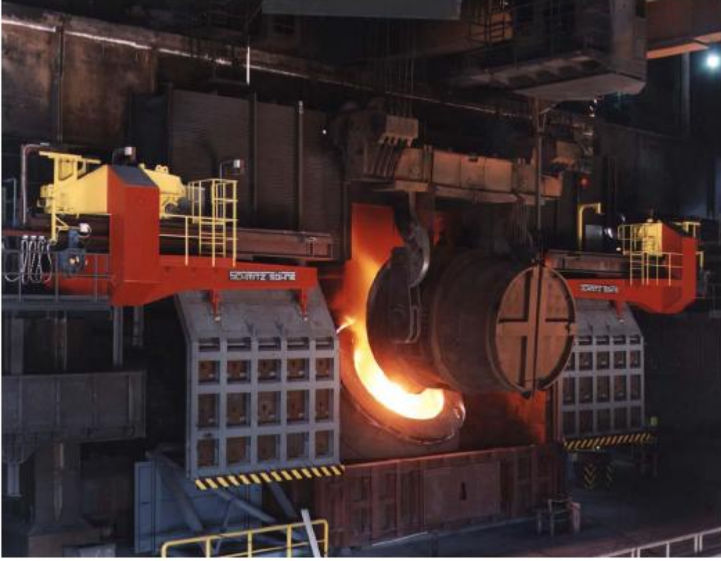
Şekil 8.1 : Sıcak metalin şarjı sırasındaki bazik oksijen fırını
