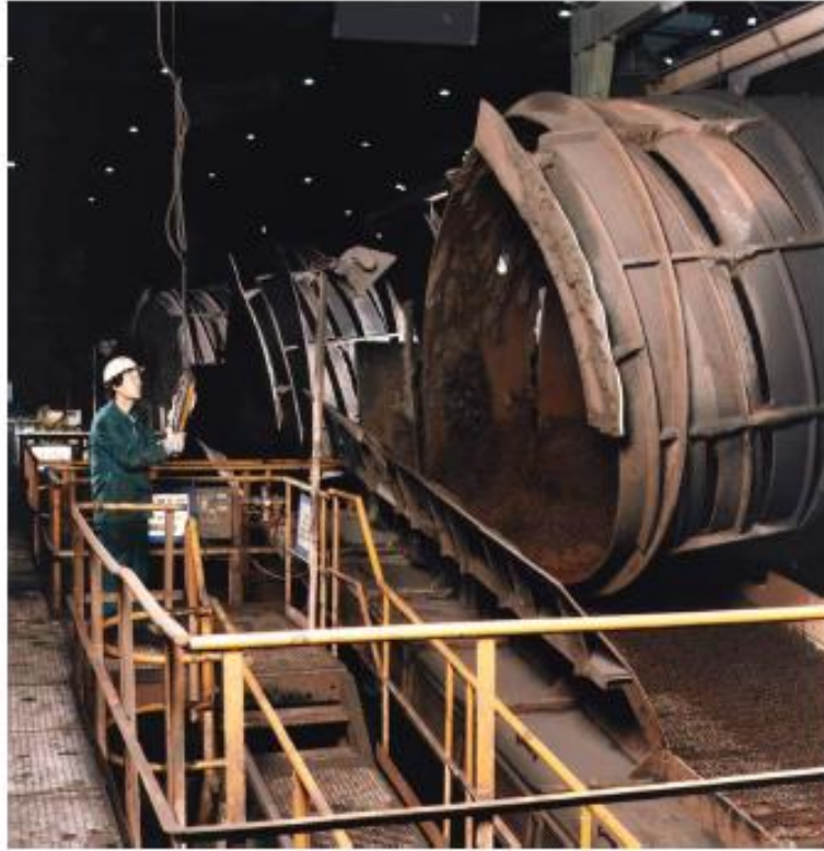
Şekil 5.1 : Peletleme tesisindeki topaklaştırıcı tambur
