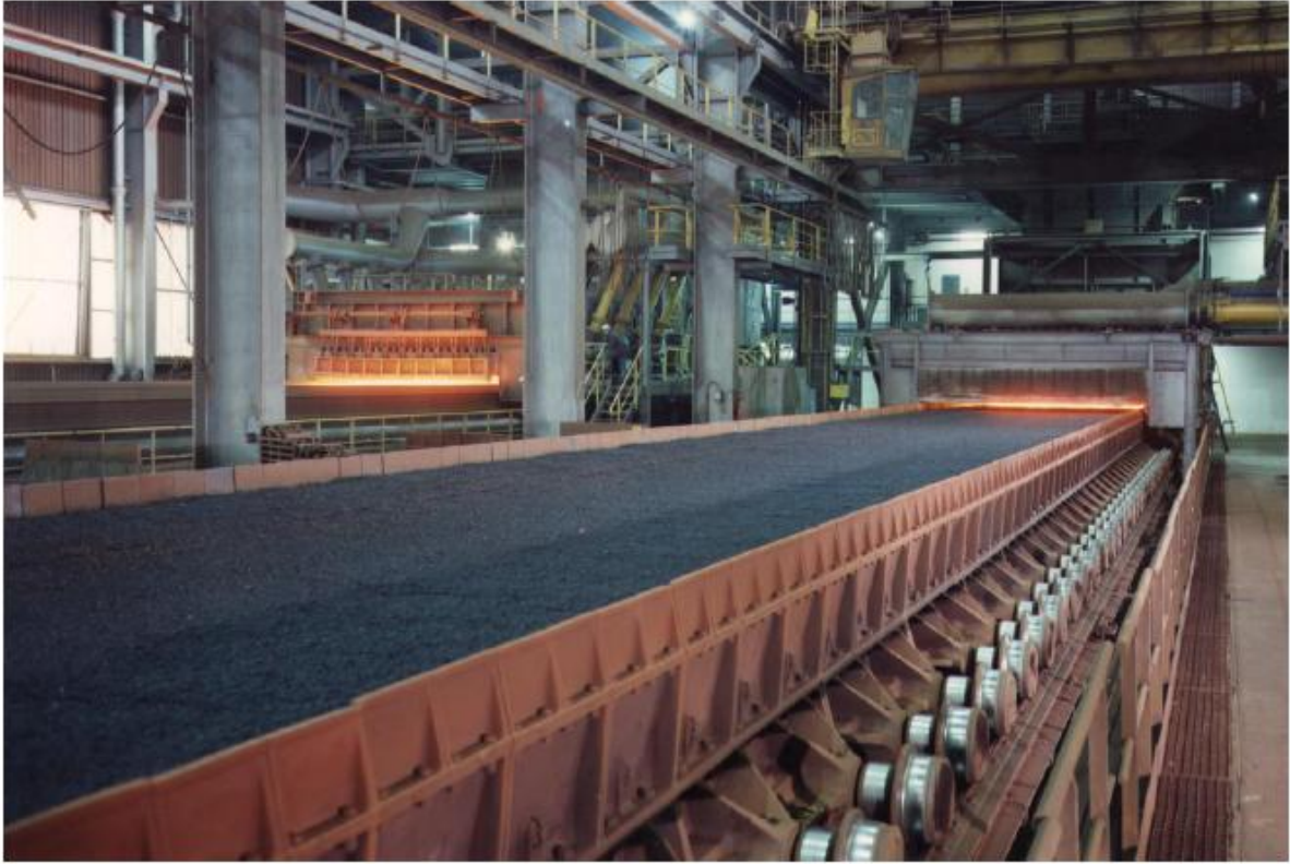
Şekil 4.1: Sinterleme sonunda şarjlama tesisi (tamburlar veya oluklar) ateşleme kabini ile bir sinter bandının fotoğrafı
